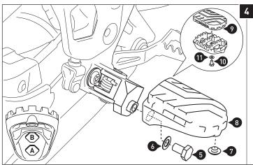
Verschrauben Sie beidseitig die Fußrasten (8) an den Gelenkadaptern (2) und (3).
