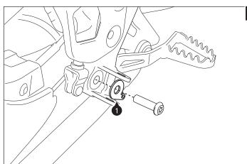
Verschrauben Sie auf der rechten Fahrzeugseite das Federblech (1) mit der originalen Schraube. Die originale Unterlegscheibe entfällt. ACHTUNG: Verwenden Sie flüssige
