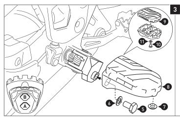
Verschrauben Sie beidseitig die Fußrasten (8) an den Gelenkadaptern (2) und (3).
