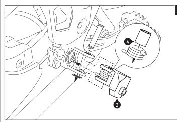
Setzen Sie die Distanzbuchsen (4) in die originale Federn ein.
