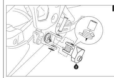
Setzen Sie die originalen Distanzbuchsen in die Federn ein.
